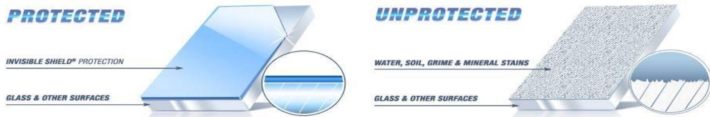
Zaštitni premaz ne omogućuje samočišćenje staklene površine, on je tu da pomogne prljavštini, vodi i kamencu da lakše klize i da omogući lakše i brže čišćenje.
